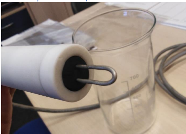
Obr. 4. Měrná část sondy z drátu korozivzdorné oceli FeCr18Ni10.
